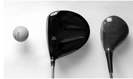
Fig.2 左はコブラ社のL4VX。最大級の慣性モーメント値(5700g cm 2 )、規定内最大のヘッド寸法、規定内最大の打面の反発係数、規定内最大のヘッド容積(460cc)などがカタログで謳われている。素材は6AL-4Vチタンとカーボンコンポジット。310g。右は1980年頃に使われていたドライバーの例/マクレガー社のターニーカスタム、ヘッドはパーシモン、シャフトはスチール製で43インチ、総重量は380g。 Left: L4VX by Cobra with the maximum MOI (5700g cm 2 ), head size, repulsion coefficient, and cubic volume (460 cc) within the regulated limit. Fabricated from 6AL-4V titanium and carbon composite. Weight 310g. Right: A driver used around 1980. Tourney Custom by MacGregor, with persimmon-made head, 43 inch long steel shaft, weighing 380g in total.
