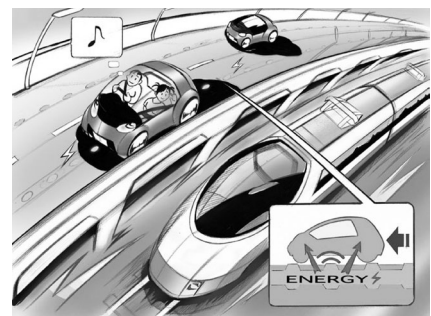
Fig.10 非接触式の活用例。高速道路の路面下から集電して走行。 Example of use of a non-touch charger.
